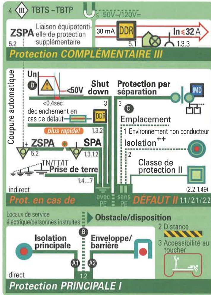
4.1.0 Figure 1: Protection contre les chocs électriques
